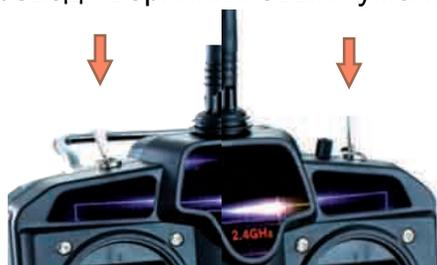
В случае когда танк не включается, необходимо забиндить передатчик с танком, для этого переводим оба верхних тумблера в положение - на себя, включаем пульт, затем включаем танк, после того как перестанет моргать лампочка на пульте, оба верхних тумблера одновременно переводим в положение от себя и далее левый тумблер на себя - танк заводится.
