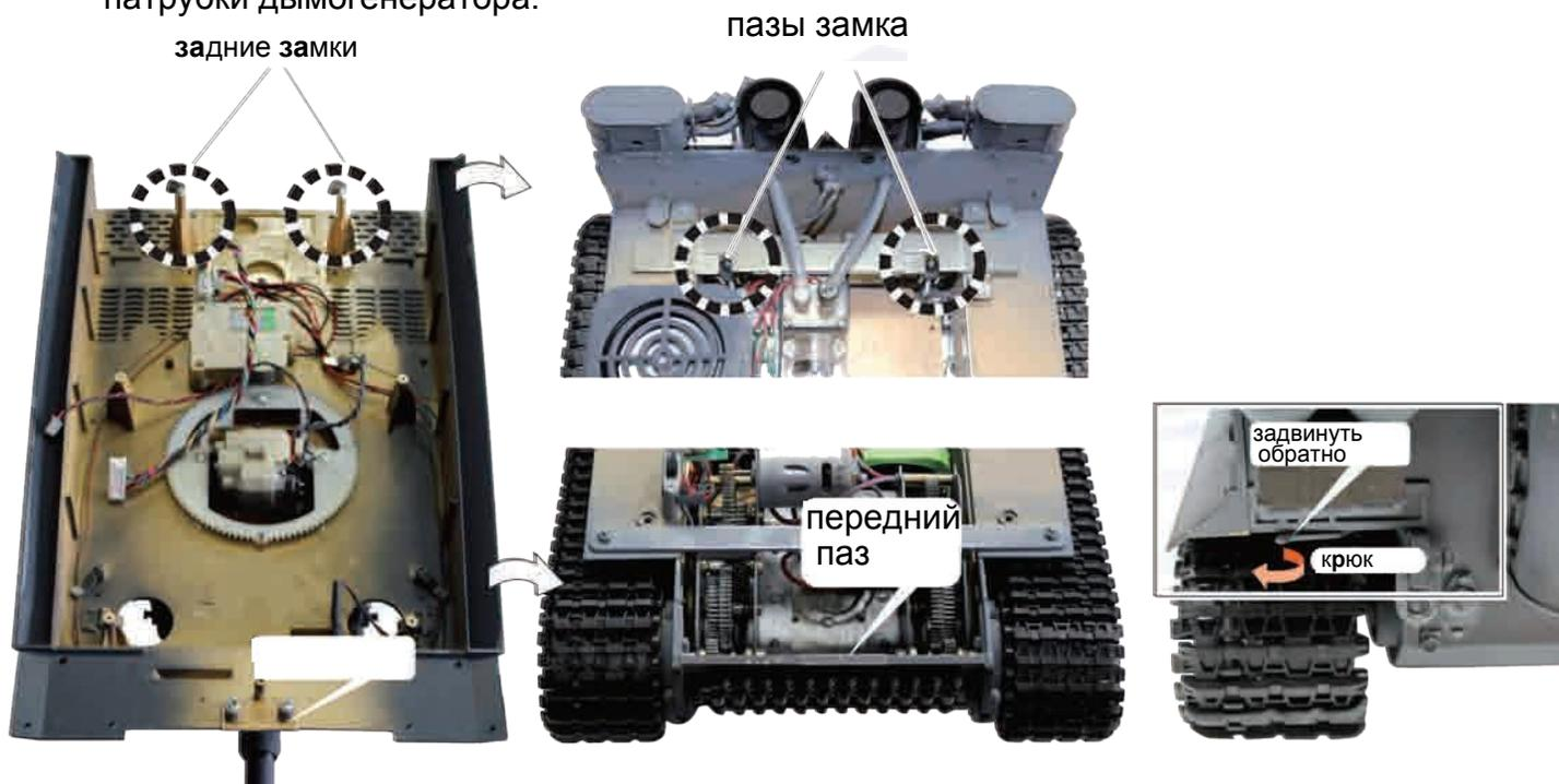
④ Установка крышки корпуса танка в обратной последовательности, верняя крышка одевается на корпус танка сверху, таким образом, чтобы передняя часть крышки задвинулась в корпус танка спереди, а на задней части замки вставить в пазы и просто защелкнуть на замок.
