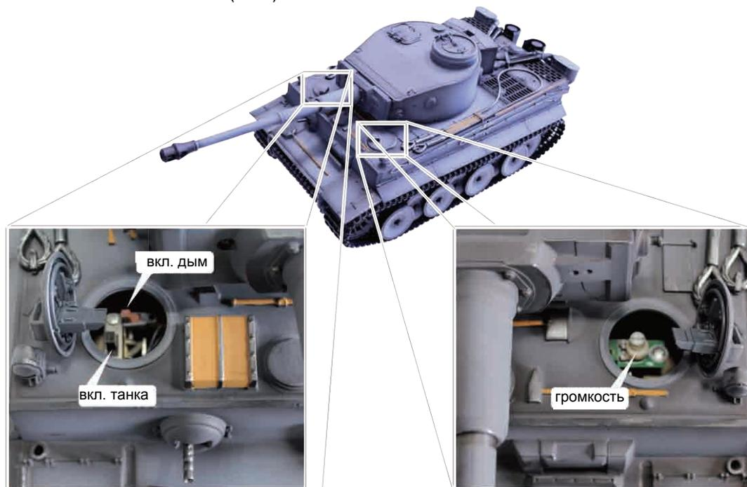
Под правым люком корпуса танка находится выключатель дымогенератора и самого танка.
