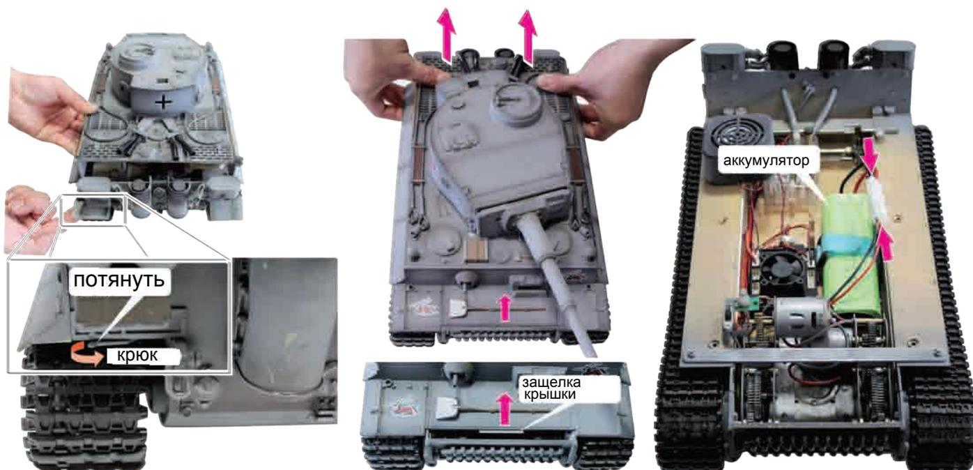
① В заднем левом углу танка под верхней крышкой находится крюк замка, его необходимо потянуть на себя, чтобы открыть замок в корпусе. Также перед тем как снимать крышку, необходимо отсоединить патрубки дымогенератора.
