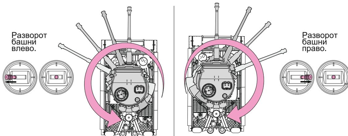
На танке установлена система фиксации крайних положений башни, которая блокирует дальнейший разворот при достижении крайней точки разворота.
